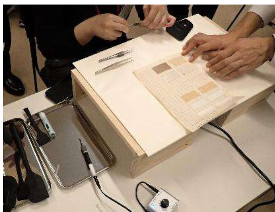
図 93. 加温台と赤外線温度計を使用したテープ除去
