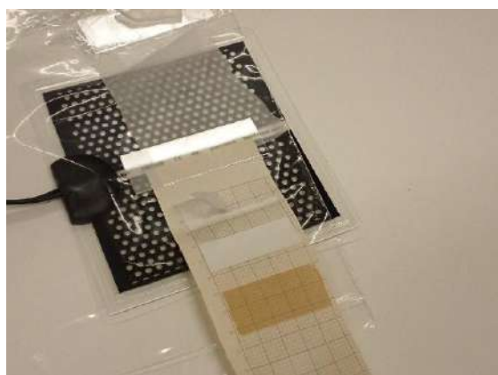
図 92. デンプン分解酵素（ \alpha アミラーゼ）の混合有機ゲル（ゲランガム）と加温シートを使用した除去
