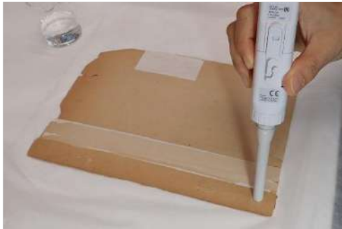
図 62. 調査（水素イオン濃度測定）
