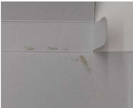
図 87. 粘着剤による保存帙の汚損
