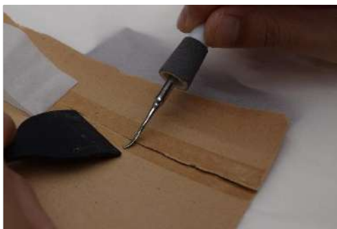
図 64. テープ除去（加温による除去）
